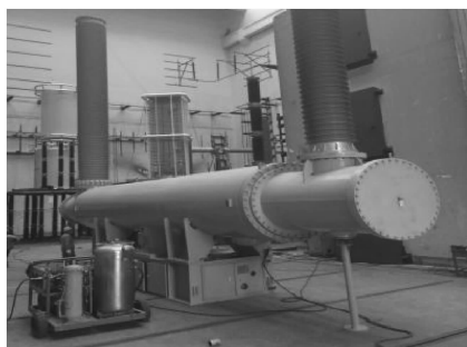
图8 1100 kV GIS 断路器实物图
